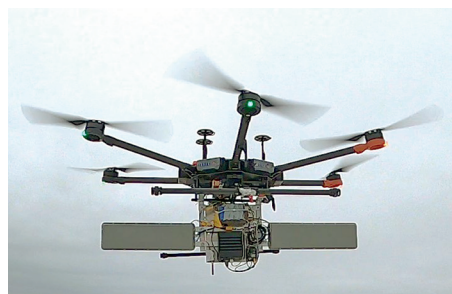
Рис. 2. Вид РЛС «Квazar» при ее размещении на БПЛА самолетного и мультикоптерного типов
